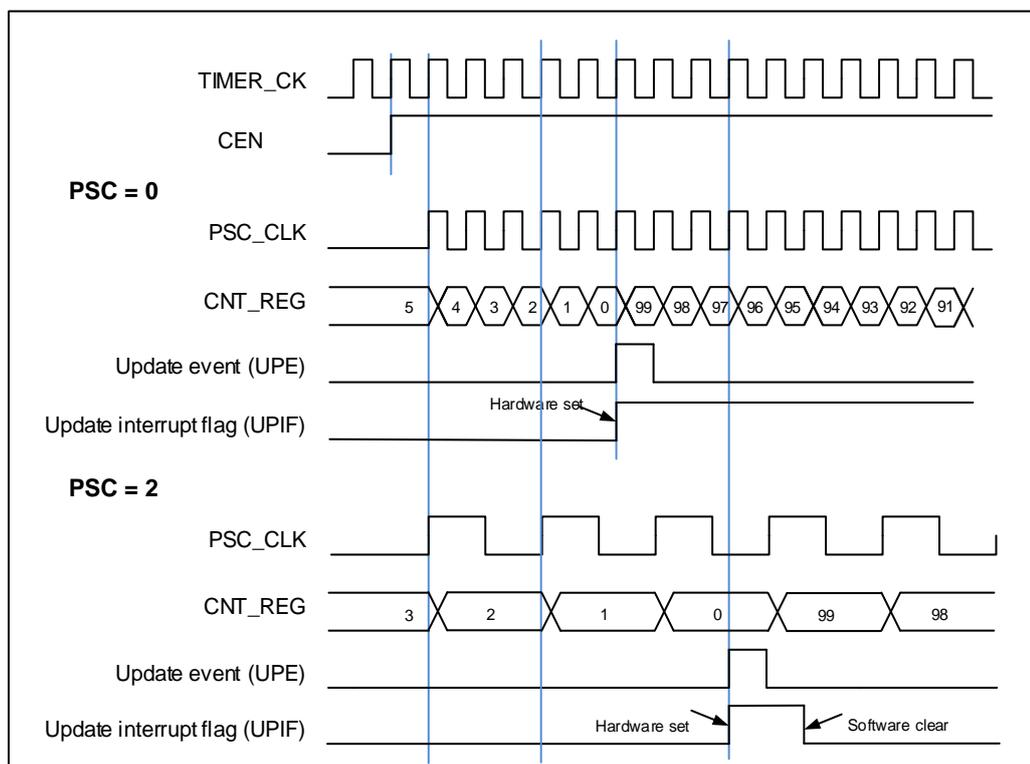
图 15-54. 向下计数时序图，在运行时改变 TIMERx\_CAR 寄存器值
