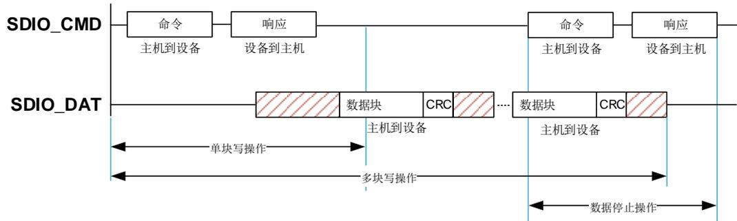
SD 存储卡、SD I/O 卡（包括仅 IO 卡和组合卡）和 CE-ATA 设备直接的数据传输是以数据块的方式完成的。MMC 卡以数据块或数据流方式进行数据传输。[图 19-4. SDIO 数据流读操作](#)和[图 19-5. SDIO 数据流写操作](#)分别是数据流的读和写操作。
