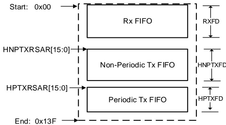
USBFS为程序提供了专有寄存器空间来读写数据FIFO。[图 24-6. 主机模式 FIFO 访问寄存器映射表](#)所描述的是数据FIFO所访问的寄存器存储空间,图中的数值是以字节为单位寻址。尽管所有的非周期通道共享相同的FIFO以及所有的周期通道共享相同的FIFO,每个通道都拥有它们的FIFO访问寄存器空间。对USBFS而言,获知当前压入数据包的通道号是非常重要的,通过寄存器USBFS\_GRXTATR/USBFS\_GRSTATP来访问数据包所从属的Rx FIFO。
