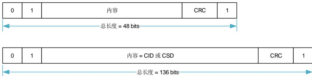
响应总是从一个起始位 (始终为 0) 开始, 随后第二位表示传输的方向 (卡=0)。下面表中的“x”的值表示为可变的。除了 R3 类型的所有响应由 CRC 校验。每个响应字段由结束位 (总是 1) 终止。
