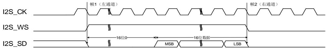
图 18-27. LSB 对齐标准时序图 (DTLEN=00, CHLEN=1, CKPL=1)
