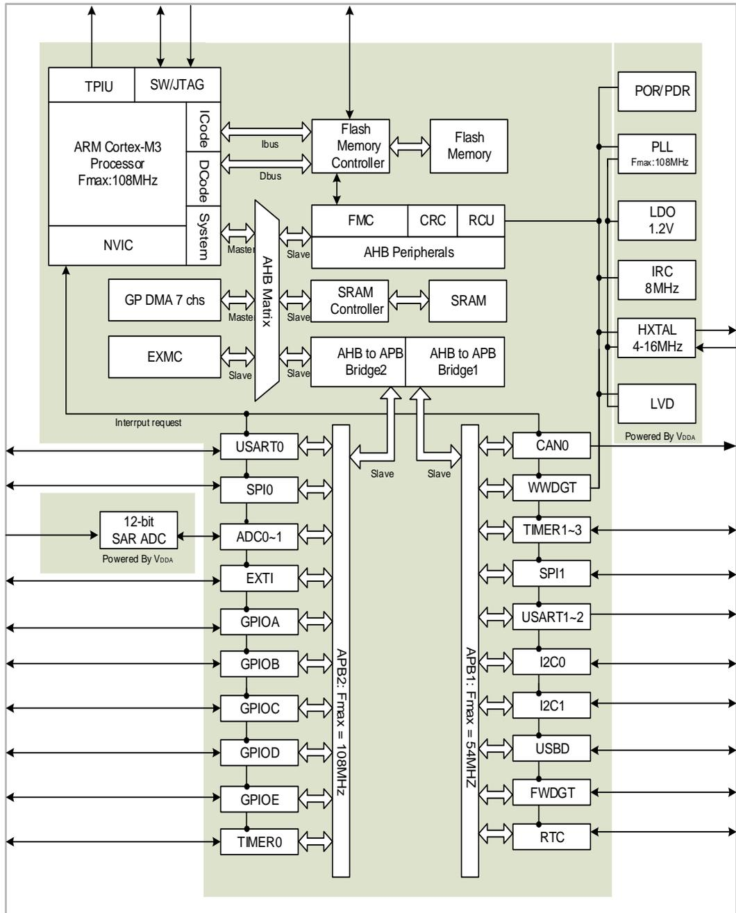
图 1-3. GD32F10x High-density 系列系统架构
