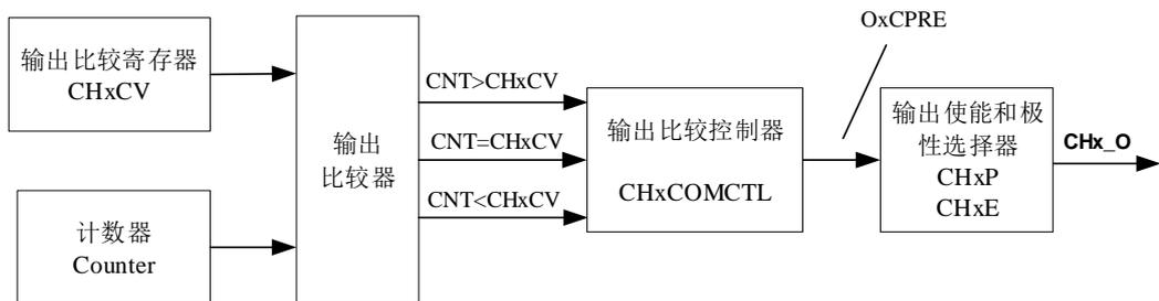
[图15-40. 通道输出比较原理 \(x=0,1,2,3\)](#) 给出了通道输出比较的原理电路。通道输出信号CHx\_O与OxCMPRE信号（详情请见[通道输出准备信号](#)）的关系描述如下：OxCMPRE信号高电平有效，CHx\_O的输出情况与OxCMPRE信号，CHxP位和CHxE位有关（具体情况请见TIMERx\_CHCTL2寄存器中的描述）。例如，当设置CHxP=0（CHx\_O高电平有效，与OxCMPRE输出极性相同）、CHxE=1（CHx\_O输出使能）时：
