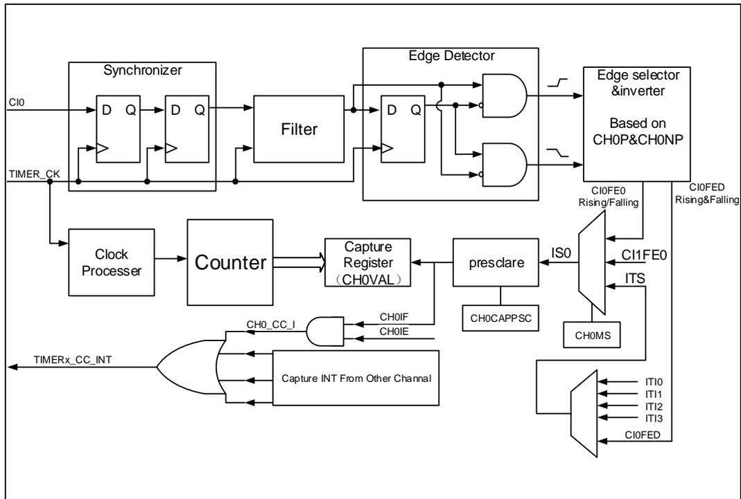
通道输入信号  $C_{ix}$  有两种选择，一种是  $TIMERx\_CHx$  信号，另一种是  $TIMERx\_CH0$ 、 $TIMERx\_CH1$  和  $TIMERx\_CH2$  异或之后的信号。通道输入信号  $C_{ix}$  先被  $TIMER\_CK$  信号同步，然后经过数字滤波器采样，产生一个被滤波后的信号。通过边沿检测器，可以选择检测上升沿或者下降沿。通过配置  $CHxP$  选择使用上升沿或者下降沿。配置  $CHxMS$ ，可以选择其他通道的输入信号，内部触发信号。配置  $IC$  预分频器，使得若干个输入事件后才产生一个有效的捕获事件。在捕获事件中， $CHxVAL$  会恢复计数器的值。
