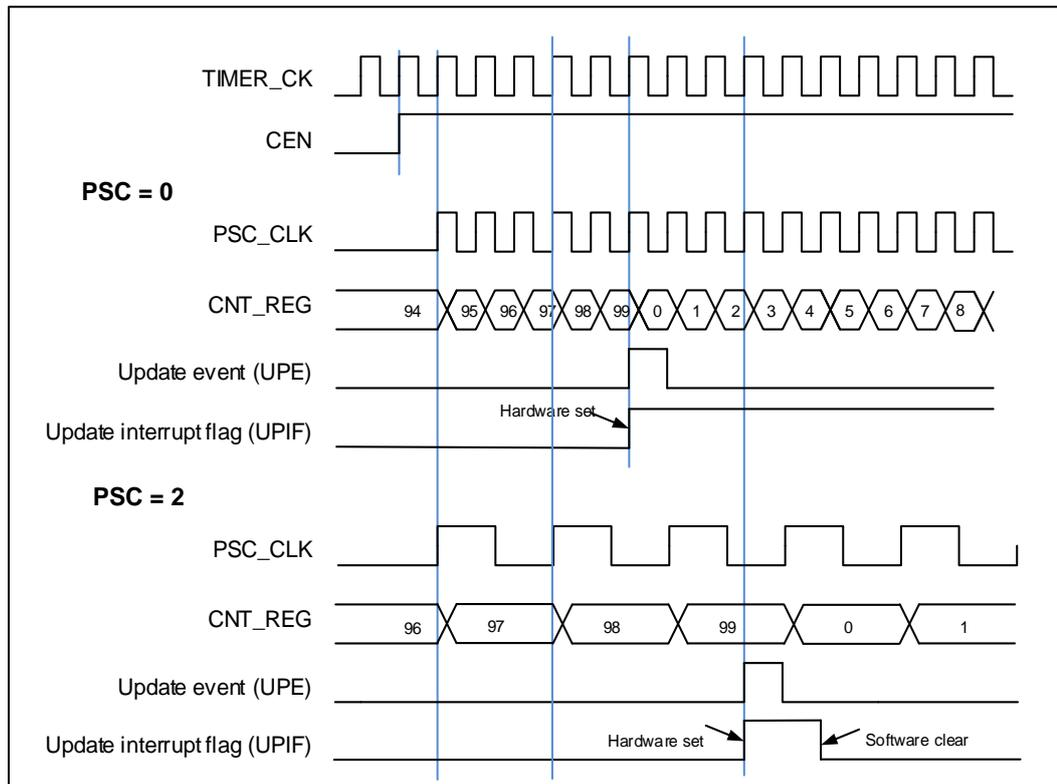
图 15-79. 向上计数时序图，在运行时改变 `TIMERx_CAR` 寄存器的值
