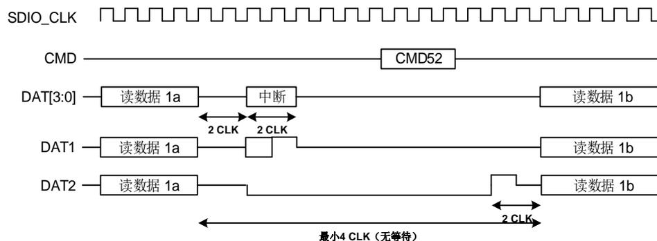
在接收到数据块之前就可以开始读等待：当数据单元使能(设置 SDIO\_DATACTL[0]位)，SD I/O 特定操作使能(设置 SDIO\_DATACTL[11]位)，开始读等待(SDIO\_DATACTL[10] = 0 并且 SDIO\_DATACTL[8] = 1)，数据方向为从卡到 SD I/O 主机 (SDIO\_DATACTL[1] = 1)，DSM 直接从空闲状态到读等待状态。在读等待时，2 个 SDIO\_CLK 时钟周期后，DSM 驱动 SDIO\_DAT[2] 为 0。在这种状态下，当设置了 RWSTOP 位(SDIO\_DATACTL[9])时，DSM 会在等待状态多停留 2 个 SDIO\_CLK 时钟周期，并在一个时钟周期中驱动 SDIO\_DAT[2]为 1。然后 DSM 再次开始等待直到从卡里接收到数据。在接收数据块时，即使设置了开始读等待，DSM 也不会开始一个读等待间隔，读等待将在收到 CRC 后开始。必须清除 RWSTOP 才能开始新的读等待操作。在读等待期间，SDIO 主机可以在 SDIO\_DAT[1]上监测 SD I/O 中断。
