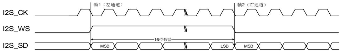
图 18-17. MSB 对齐标准时序图 (DTLEN=00, CHLEN=0, CKPL=1)
