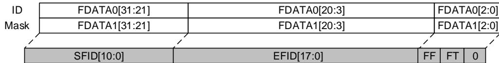
图 21-8. 16-bit 位宽掩码模式过滤器
