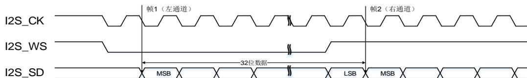
当32位数据打包成32位数据帧的帧格式时，每完成1帧数据的传输需要访问SPI\_DATA寄存器2次。在发送模式下，如果要发送一个32位数据，第一个写入SPI\_DATA寄存器的数据应该是高16位数据，第二个数据应该是低16位数据。在接收模式下，如果要接收一个32位数据，第一
