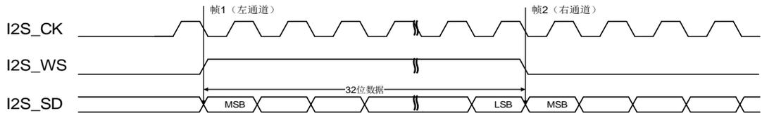
图 18-19. MSB 对齐标准时序图 (DTLEN=10, CHLEN=1, CKPL=1)
