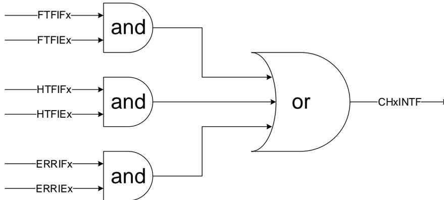
注意：“x”表示通道数（DMA0对应x=0...6；DMA1对应x=0...4）
