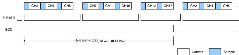
常规序列中断运行模式的软件流程：
