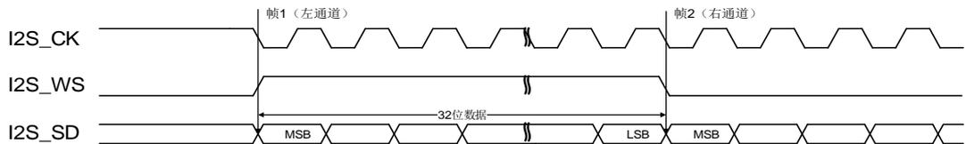
图 18-20. MSB 对齐标准时序图 (DTLEN=01, CHLEN=1, CKPL=0)
