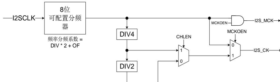
I2S时钟生成器框图如[图18-44. I2S时钟生成结构框图](#)所示。I2S接口时钟是通过SPI\_I2SPSC寄存器的DIV位，OF位和MCKOEN位以及SPI\_I2SCTL寄存器的CHLEN位来配置的。I2S可以选择PLL2或者CK\_SYS得到更准确的时钟。I2S比特率可以通过[表18-6. I2S比特率计算公式](#)所示的公式计算。
