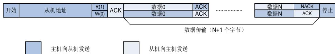
图 17-7. 10 位地址的 I2C 通讯流程（主机发送）
