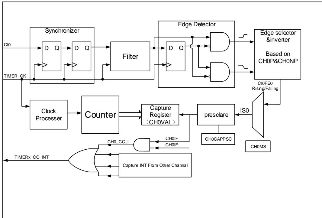
通道输入信号Cix先被TIMER\_CK信号同步，然后经过数字滤波器采样，产生一个被滤波后的信号。通过边沿检测器，可以选择检测上升沿或者下降沿。通过配置CHxP选择使用上升沿或者下降沿。配置CHxMS.，可以选择其他通道的输入信号，内部触发信号。配置IC预分频器，使得若干个输入事件后才产生一个有效的捕获事件。捕获事件发生，CxCV存储计数器的值。
