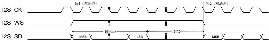
图 18-23. MSB 对齐标准时序图 (DTLEN=00, CHLEN=1, CKPL=1)
