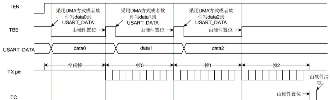
在禁用USART或进入低功耗状态之前，必须等待TC置位。先读USART\_STAT然后再写USART\_DATA可将TC位清0。在多级缓存通信方式（DENT=1）下，直接向TC写0，也能清TC。
