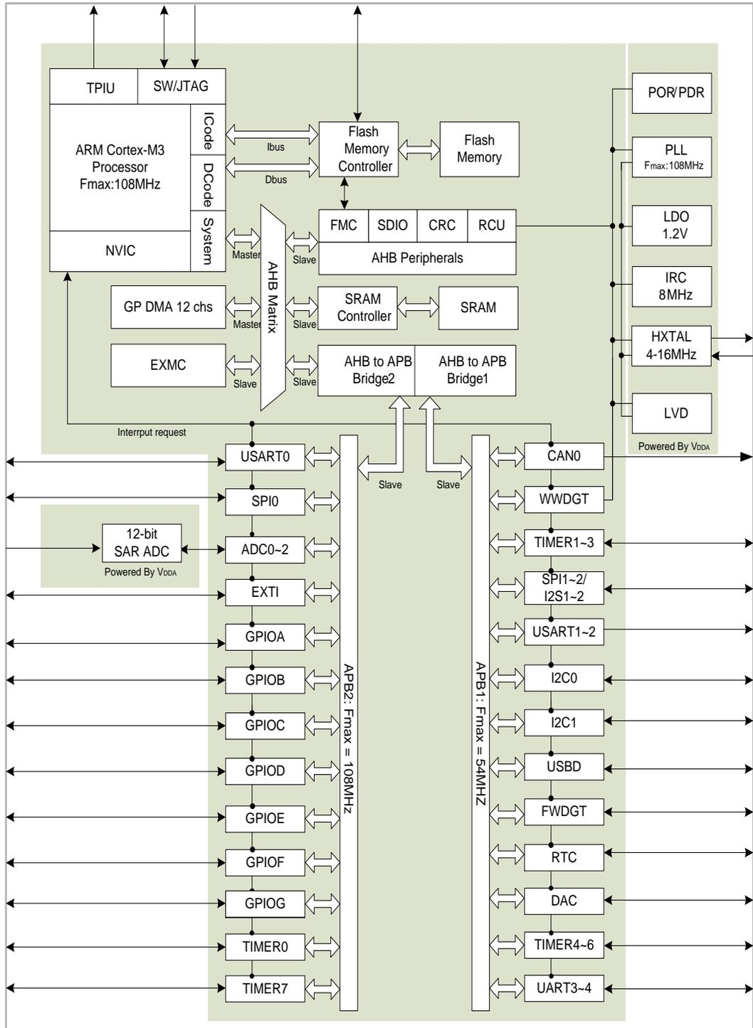
图 1-4. GD32F10x Extra-density 系列系统架构
