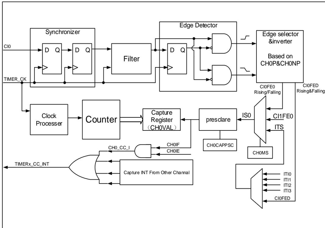
通道输入信号 $CIx$ 先被 $TIMER\_CK$ 信号同步，然后经过数字滤波器采样，产生一个被滤波后的信号。通过边沿检测器，可以选择检测上升沿或者下降沿。通过配置 $CHxP$ 选择使用上升沿或者下降沿。配置 $CHxMS$ ，可以选择其他通道的输入信号，内部触发信号。配置 $IC$ 预分频器，使得若干个输入事件后才产生一个有效的捕获事件。捕获事件发生， $CxCV$ 存储计数器的值。
