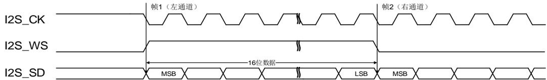
图 18-18. MSB 对齐标准时序图 (DTLEN=10, CHLEN=1, CKPL=0)
