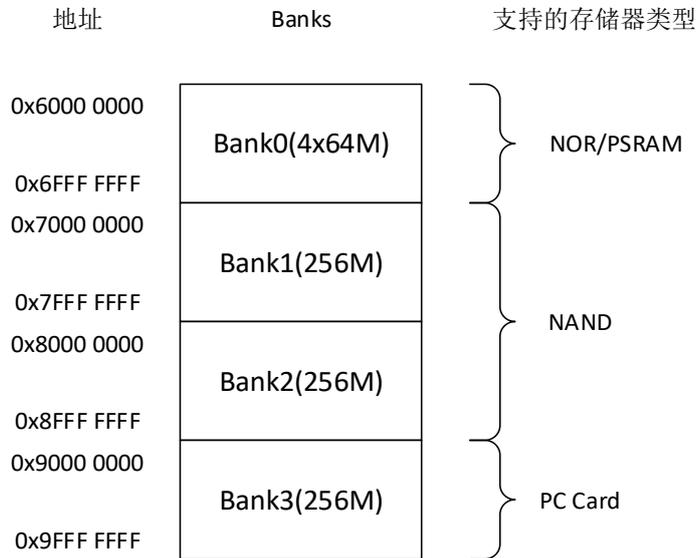
EXMC将外部存储器分成多个Bank，每个Bank占256M字节，其中Bank0又分为4个Region，每个Region占64M字节。Bank1和Bank2又都被分成2个Section，分别是属性存储空间和通用存储空间。Bank3分成3个Section，分别是属性存储空间，通用存储空间和I/O存储空间。
