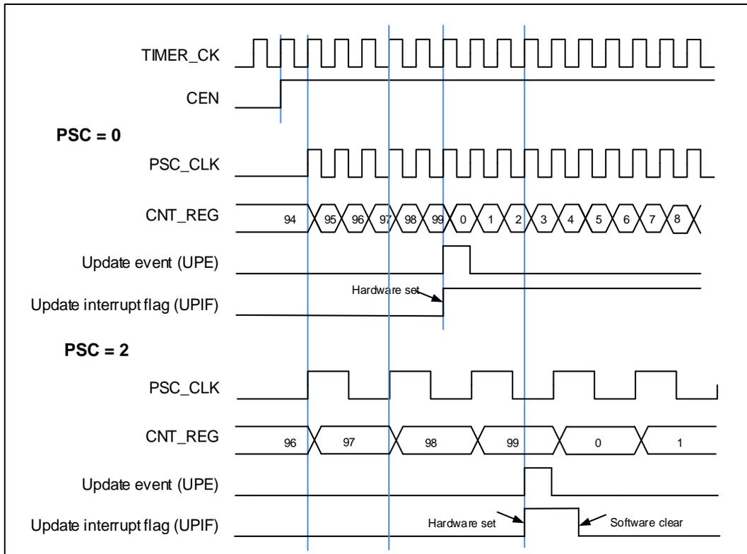
图 15-69. 向上计数时序图，在运行时改变 `TIMERx_CAR` 寄存器的值
