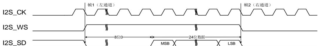
图 18-25. LSB 对齐标准时序图 (DTLEN=01, CHLEN=1, CKPL=1)
