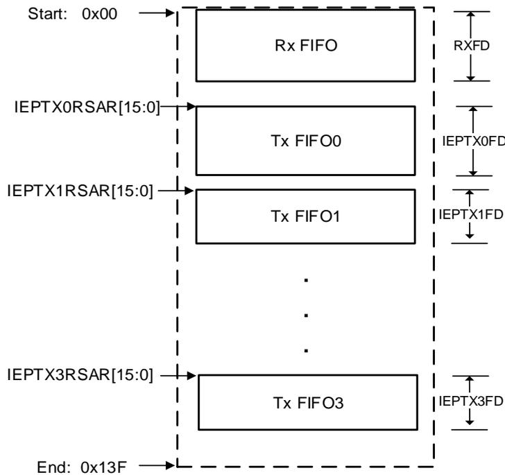
USBFS 为程序提供了专有寄存器空间来读写数据 FIFO。[图 24-8. 设备模式 FIFO 访问寄存器映射表](#)所描述的是数据 FIFO 所访问的寄存器存储空间，图中的数值是以字节为单位寻址。每个端点都拥有它们的 FIFO 访问寄存器空间。通过寄存器 USBFS\_GRXTATR/USBFS\_GRSTATP 来访问 Rx FIFO。
