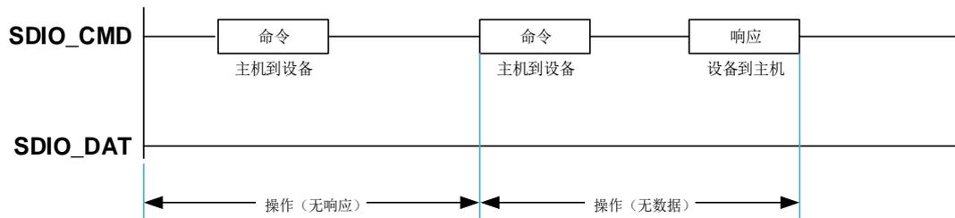
多块操作模式比单块操作速度更快。当 CMD 信号线上出现停止命令时，多块传输终止。主机数据传输可以使用单个或多个数据线。多个块的读操作如 [图 19-2. SDIO 多块读操作](#) 所示，多个块的写操作如 [图 19-3. SDIO 多块写操作](#) 所示。块的写操作在数据 (DAT0) 信号线上使用忙信号。CE-ATA 设备在准备接收数据之前有一个可选的忙信号。
