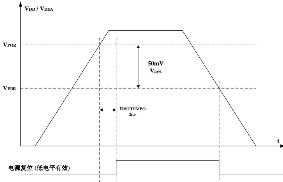
LVD 的功能是检测  $V_{\text{DD}} / V_{\text{DDA}}$  供电电压是否低于低电压检测阈值，该阈值由电源控制寄存器 (PMU\_CTL) 中的 LVDT[2:0]位进行配置。LVD 通过 LVDEN 置位使能，位于电源状态寄存器 (PMU\_CS) 中的 LVDF 位表示低电压事件是否出现，该事件连接至 EXTI 的第 16 线，用户可以通过配置 EXTI 的第 16 线产生相应的中断。[图 3-3. LVD 阈值波形图](#)显示了  $V_{\text{DD}} / V_{\text{DDA}}$  供电电压和 LVD 输出信号的关系。(LVD 中断信号依赖于 EXTI 第 16 线的上升或下降沿配置)。迟滞电压  $V_{\text{hyst}}$  值为 100mV。
