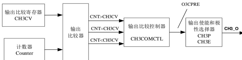
图15-13. 通道输出比较原理（带有互补输出的通道，x=0,1,2）和图15-14. 通道输出比较原理分别给出了通道输出比较的原理电路。通道输出信号CHx\_O/CHx\_ON与OxCPRE信号（详情请见[通道输出准备信号](#)）的关系描述如下：OxCPRE信号高电平有效，CHx\_O/CHx\_ON的输出情况与OxCPRE信号，CHxP/CHxNP位和CHxE/CHxNE位有关（具体情况请见TIMERx\_CHCTL2寄存器中的描述）。例如：
