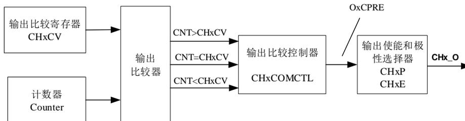
[图15-57. 通道输出比较原理 \(x=0,1\)](#) 给出了通道输出比较的原理电路。通道输出信号CHx\_O与OxCPRE信号（详情请见[通道输出准备信号](#)）的关系描述如下：OxCPRE信号高电平有效，CHx\_O的输出情况与OxCPRE信号，CHxP位和CHxE位有关（具体情况请见TIMERx\_CHCTL2寄存器中的描述）。例如，当设置CHxP=0（CHx\_O高电平有效，与OxCPRE输出极性相同）、CHxE=1（CHx\_O输出使能）时：
