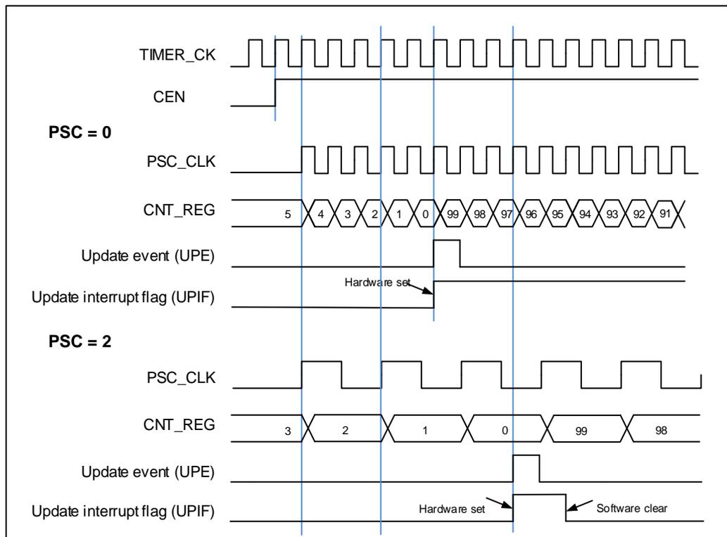
图 15-37. 向下计数时序图，在运行时改变 TIMERx\_CAR 寄存器值
