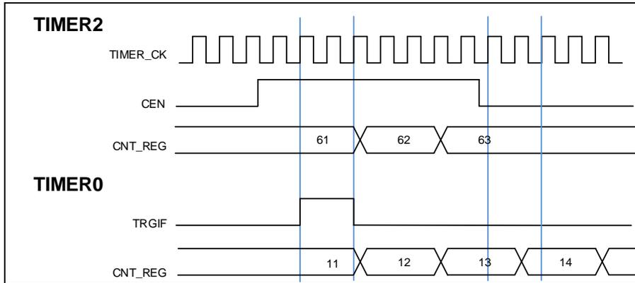
■ 使用一个外部触发来同步两个定时器
