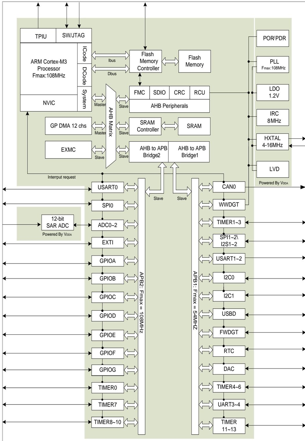
图 1-5. GD32F10x Connectivity line 系列系统架构
