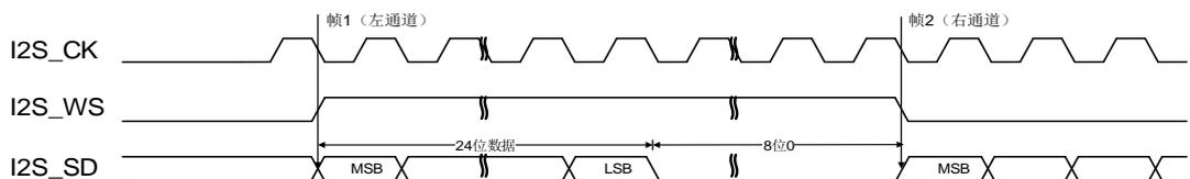
图 18-21. MSB 对齐标准时序图 (DTLEN=01, CHLEN=1, CKPL=1)
