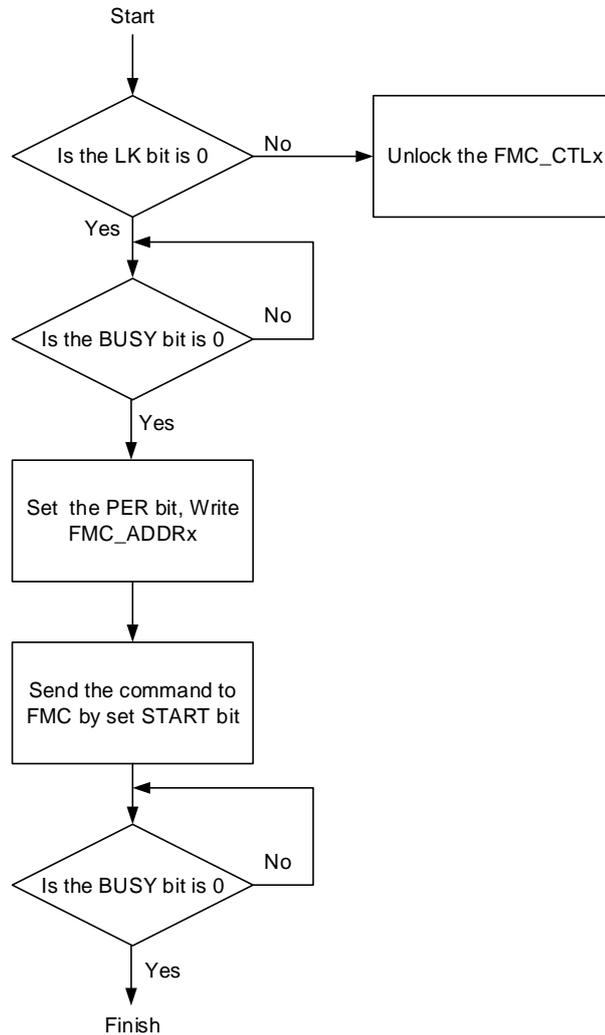
对于GD32F10x\_CL和GD32F10x\_XD，FMC\_STAT0寄存器反应对bank0和选项字节块的操作状态，FMC\_STAT1反应对bank1的操作状态。对bank1的页擦除操作与对bank0的页擦除操作类似。需要注意的是，在安全保护状态下，对bank1的页擦除，需将地址同时写至FMC\_ADDR1和FMC\_ADDR0寄存器。
