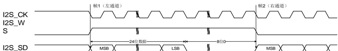
图 18-22. MSB 对齐标准时序图 (DTLEN=00, CHLEN=1, CKPL=0)
