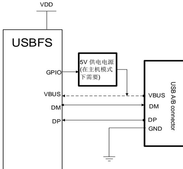
当USBFS工作在主机模式下时（FHM控制位置位、FDM控制位清除），VBUS为USB协议所定义的5V电源检测引脚。内部PHY不能提供5V VBUS电源，仅在VBUS信号线上具有电压比较器和充电放电电路。所以，如果应用需要提供VBUS电源，那么则需要一个外部的供电电源IC。在主机模式下，USBFS和USB接头之间的VBUS连接可以被忽略，这是由于USBFS并不检测VBUS引脚的电平状态，并假定5V供电电源一直存在。
