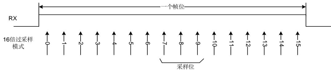
通过置位USART\_CTL0寄存器中的PCEN位使能奇偶校验功能，接收器在接收一个数据帧时计算预期奇偶校验值，并将其与接收到的奇偶校验位进行比较。如果不相等，USART\_STAT寄存器中PERR被置位。如果设置了USART\_CTL0寄存器中的PERRIE位，将产生中断。
