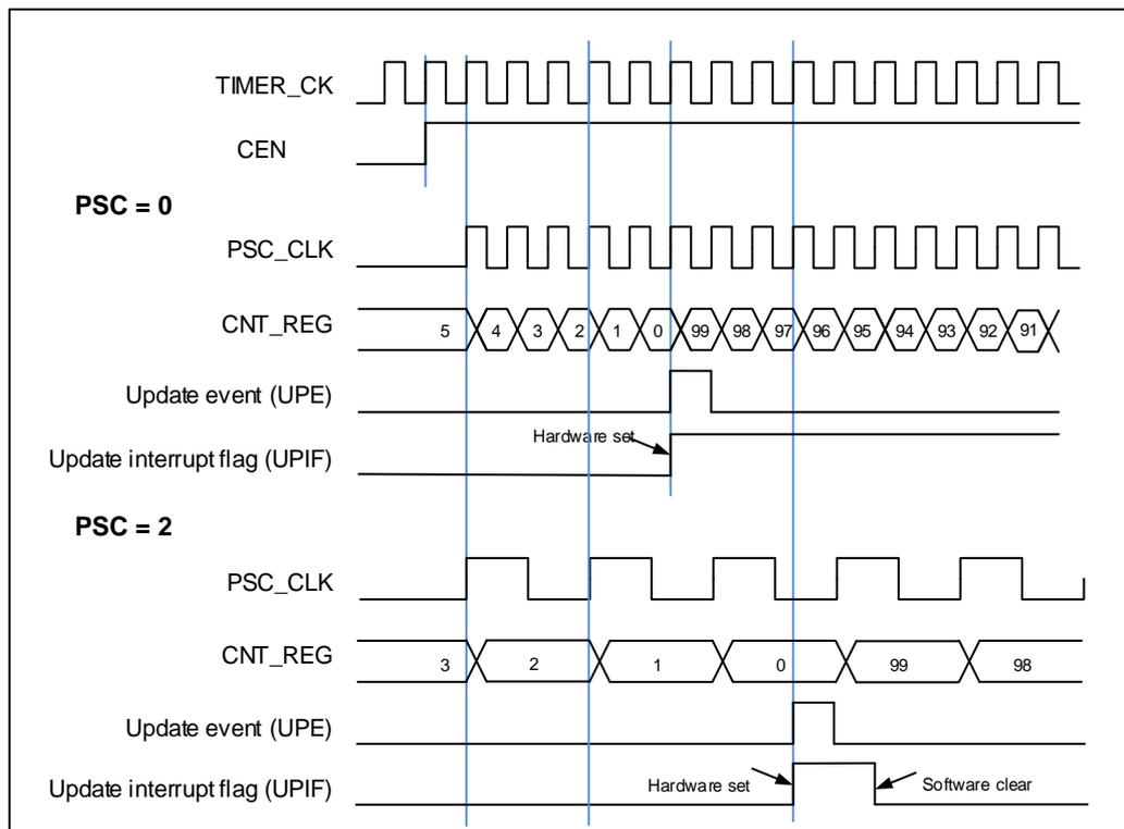
图 15-7. 向下计数时序图，在运行时改变 `TIMERx_CAR` 寄存器值
